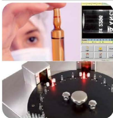
电脑显示屏及灯检台
