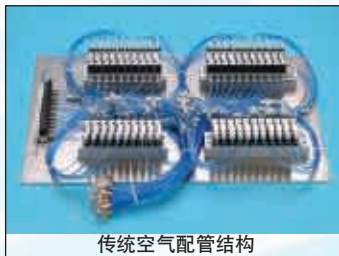
传统空气配管结构
